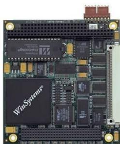
Fig. 6: Exemplo de uma board PC-104.
